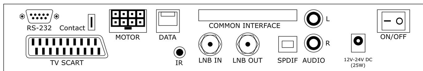
**LNB in** : Relié au câble coaxial du LNB.
